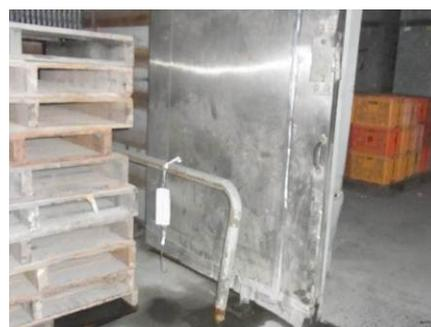
写真4.3-3 温湿度測定センサーの設置状況
